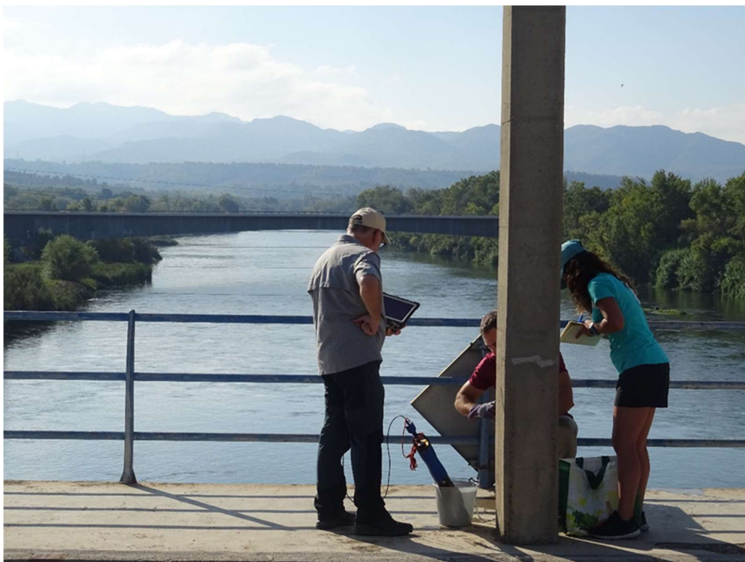
Fotografía 1: Mediciones in situ del equipo de la Universidad de Lleida de parámetros físico-químicos en el puente de Mora de Ebro (8/9/2023).
