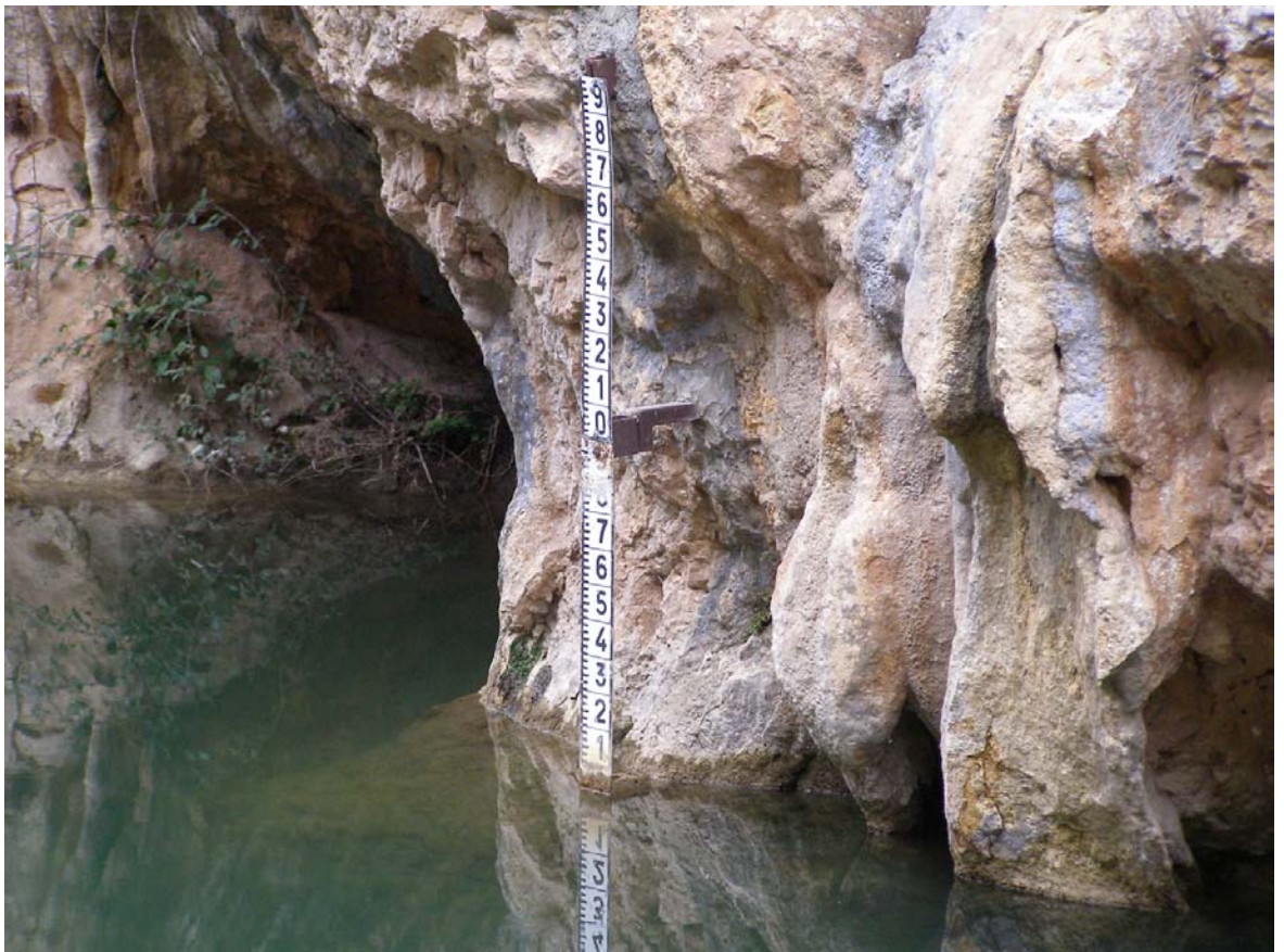
Ref. 12.- Toma de agua para abastecimiento a Huesca: detalle de la escala.
