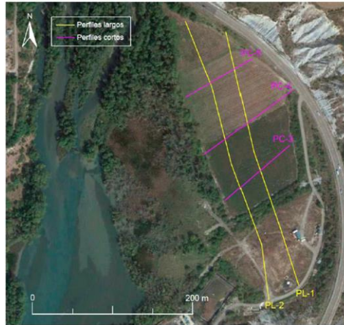
Figura 13. Líneas de tomografía eléctrica realizadas en las parcelas al pie del vertedero en 2019 por el grupo MENODES
